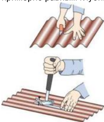
Рис. 18. Разрезка листа и вытаскивание неудачно вбитого гвоздя
